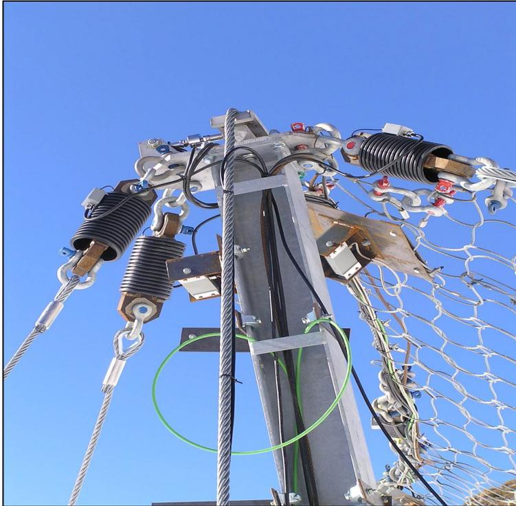
**Abb.14:** Instrumentiertes Schneenet auf dem Hafelekar zur Ermittlung von auftretenden Kräften.
