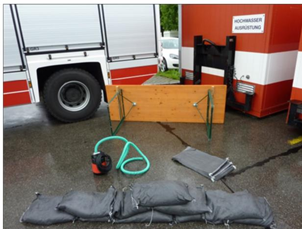
**Abb. 3:** Einfachste technische Maßnahmen – hier Sandsäcke, Wasserpumpe für den Hausgebrauch und Wirtschaftsgarnitur – können bereits Schaden im Ereignisfall Hochwasser oder Starkregen verhindern, Erlernen des Umgangs, die Wahrnehmung von Warnungen und Beschaffung vorausgesetzt.
