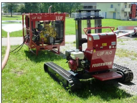
**Abb. 4:** Tauchpumpe mit Hydraulikantrieb mit einer Leistung von ca. 10.000 Liter pro Minute mit geländegängigem Raupenstapler für den Katastropheneinsatz.
