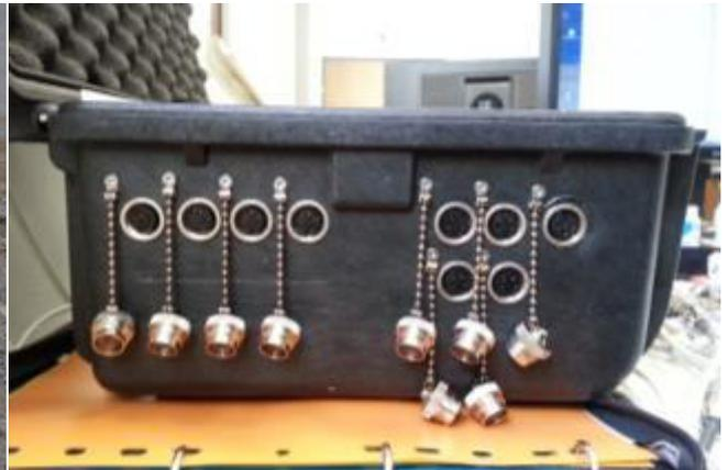
**Abb. 7:** Wasserdichte Sensorenschnittstellen
