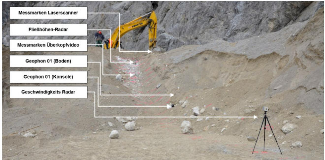
**Abb. 12:** Versuchsrinne (aus Scheikl et. al. 2014)
